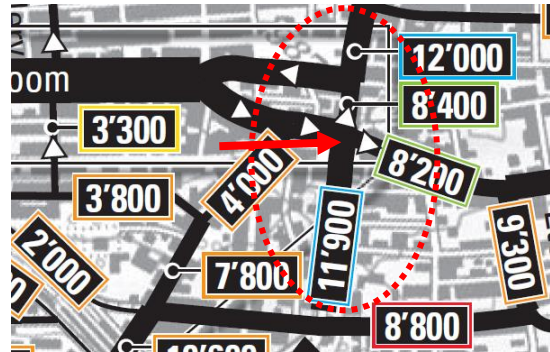
Figure 48. Plan de charge de trafic en vieille ville. En unité véhicule par jour (uv/j). Source : Transitec, 2010 (modifié).
